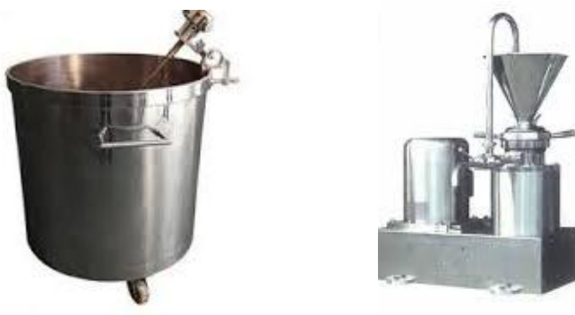
Слика 32. а) миксер, б) колоидна мелница
